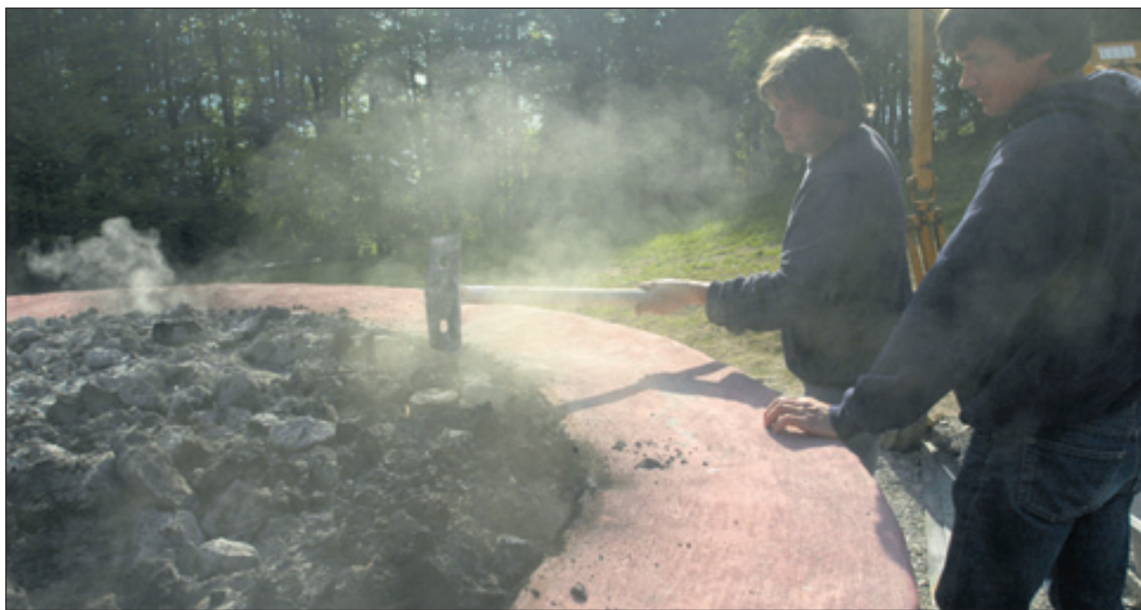
Stichprobe: Gerold Ulrich prüft, wie weit die Kalksteine schon durchgeglüht sind. Am Ende des Brennvorgangs lassen sich die spröde gewordenen Steine in Wasser zu einem feinkörnigen Kalkbrei für Verputze und Anstriche auflösen. Mittels zugesetzter Farbpigmente lässt sich die Tönung des Kalkgemischs variieren.
